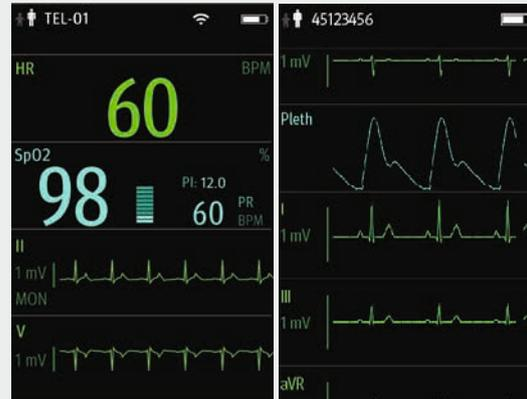
Umfangreiche Anzeige von EKG-Kurven und -Parametern durch Zusammenfügen von zwei Displays
